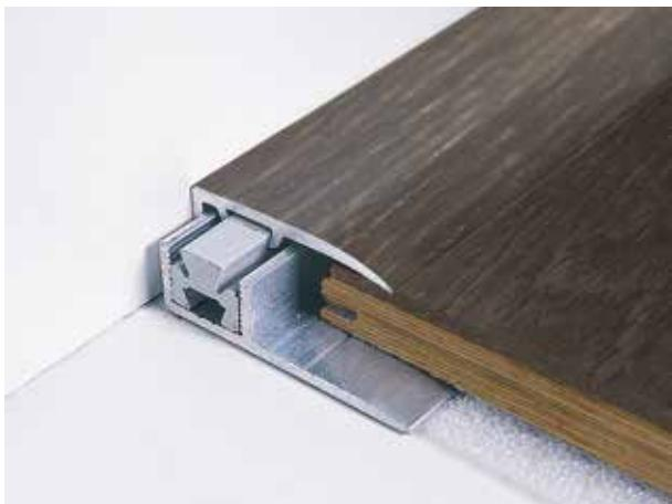
Das Profil wird einerseits als Wandabschluß- und andererseits als Dehnungsprofil verwendet, von der innere Hohlraum von 16 mm einen Bewegungsspielraum von +/- 5 mm zuläßt. Zusätzlich ersetzt es sockelleisten und kann als Fußmattenrand oder als Abschlußprofil bei Schiebetüren eingesetzt werden.
